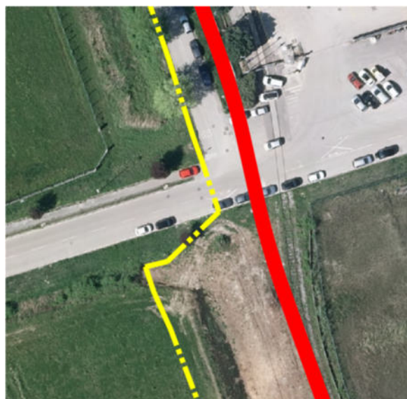
Figura 4 - Dettagli interferenze con azotodotto (in giallo)
