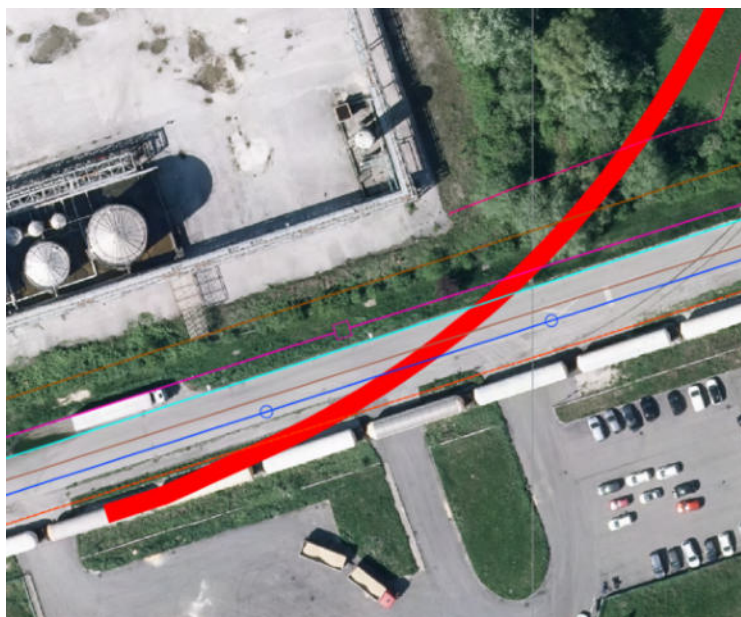
Figura 3 - interferenze del tracciato di progetto nell'attraversamento di via Majorana
