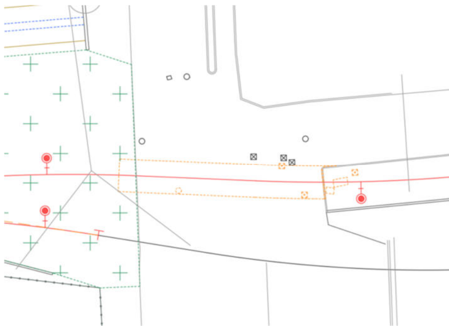
Figura 5 - dettaglio dei pozzetti di via Majorana; in rosso l'asse di progetto, in giallo i pozzetti interferenti
